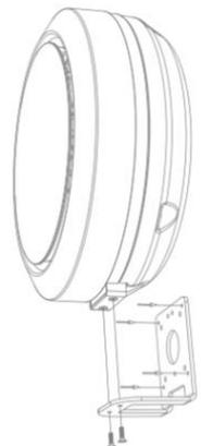
2. Verwenden Sie zwei Schrauben, um den Sockel des Uniq-Gerätes an der Wandhalterung zu befestigen. Siehe nebenstehendes Bild.
