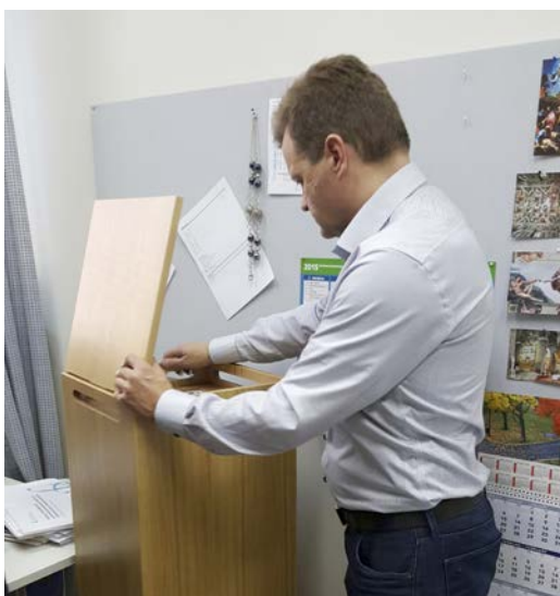
Uniqair-ilmanpuhdistimen esisuodattimen vaihto on yksikertainen kahdesti vuodessa tehtävä huoltotoimenpide.
